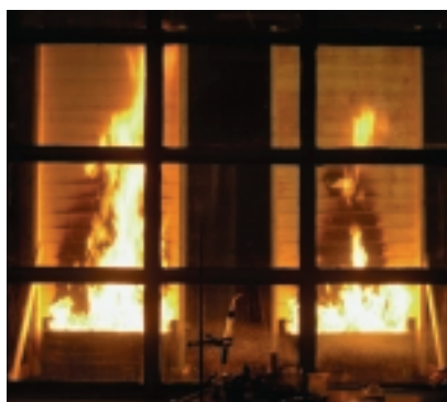
Testing av brannimpregnert kledning ved tilført varme nedenfra.
