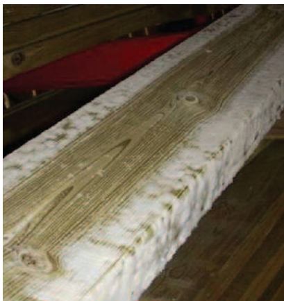
Figur 2. Muggsopp på impregnerert tre på grunn av høy fuktighet etter impregneringen. Foto: Treteknisk.
