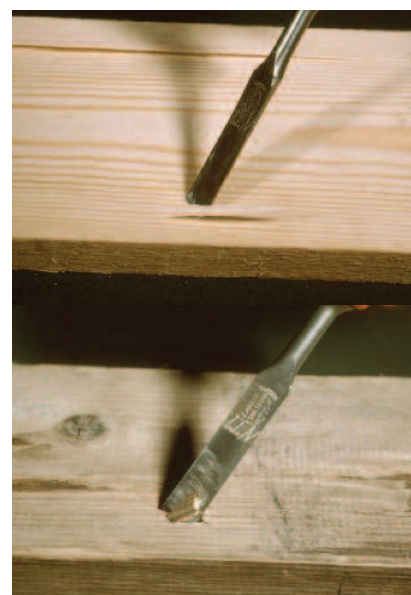
Figur 5. Øverst, friskt virke som gir brudd med lange flis. Nederst, råteangrepet virke med kort tverrbrudd. Foto: Treteknisk.
