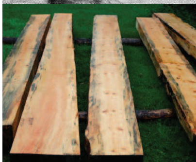
Figur 3. Blåvedsopp. Legg merke til den tynne hyfestrengen som trenger gjennom celleveggen, jfr. figur 7. Nederst ser vi furu med blåved i yteveden. Foto: Gangsei (nederst).
