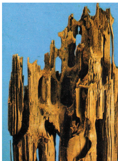
Figur 6. Stokkmaurlarver og egg på isoporisolasjon, stokkmaur og skadet tre. Foto: Mycoteam og Treteknisk.
