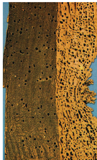
Figur 2. Stripet borebille. Larve, insekt og skade. Legg merke til rekken med fordypninger på dekkvingene (og det latinske navnet punctatum ).
