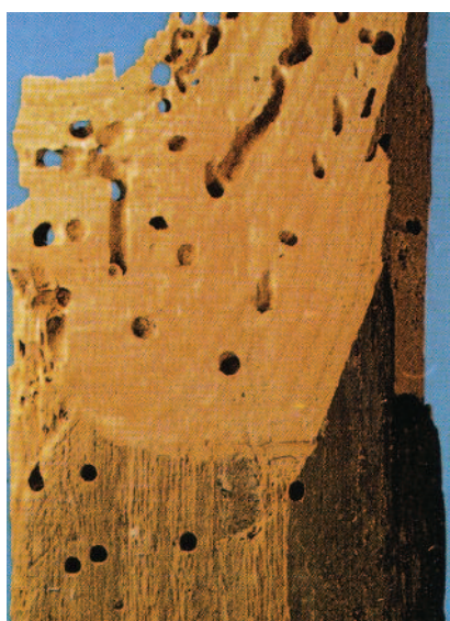
Figur 3. Råteborebille. Insekt og skade. Det er duskene på siden av hodet som lettest skiller den fra stripet borebille.
