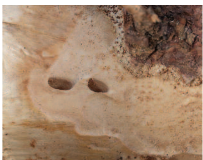
Figur 5. Blåbukke. Larve, insekt og skade. Gangene gnages av larven i kambielaget og blir fordypninger i vedens overflate når barken faller av. Legg merke til forpupningshullet og brunt og hvitt boremel av bark og ved.
